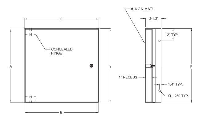
STANDARD FEATURES: STAINLESS STEEL SCREW DRIVER OPERATED CAM LATCH, CARBON STEEL, PRIME COAT BAKED ENAMEL FINISH
